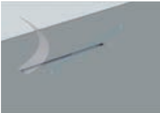
Düzeltilme betonuna astar sürünüz. İzolasyon bantını metal-beton birleşimine yapıştırınız.* Apply priming coat to leveling concrete. Adhere the isolation tape to the metal-concrete.*
